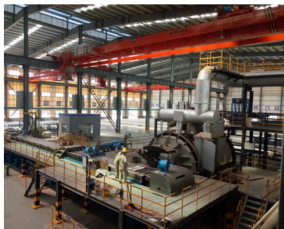
是100kt/a及以上阴极锌熔铸装备，实现了超大型有芯感应电炉的功率智能调节，炉内温度精准控制，铸锭、码垛、打捆、计量的智能化作业，锌直收率较传统锌熔铸生产线提高1%—2%，占地减少40%，单位投资降低26%，产线操作人员由120人减到32人，单位能耗降低12%。经中国有色金属工业协会成果评价：“项目整体技术达到国际领先水平，比当前世界最大电锌炉能力提高50%，降低人工成本82.1%，技术经济指标先进，为我国锌冶炼行业绿色开发和资源高效利用提供技术支撑与工程范例，可推动行业科技进步，提高市场竞争力。”株洲公司将以此次获奖为新起点，积极发挥国家制造业单项冠军企业的示范引领作用，在阴极锌熔铸装备领域继续深耕，加快科技创新步伐，推动产业发展升级，为建设制造强国提供有力支撑。
